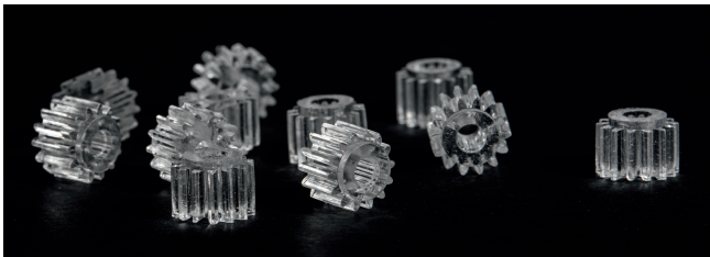
Spritzgießen, Entbindern, Sintern – ein nachhaltiger Weg zu hochwertigen Glasbauteilen in optischer Qualität. © Engel
